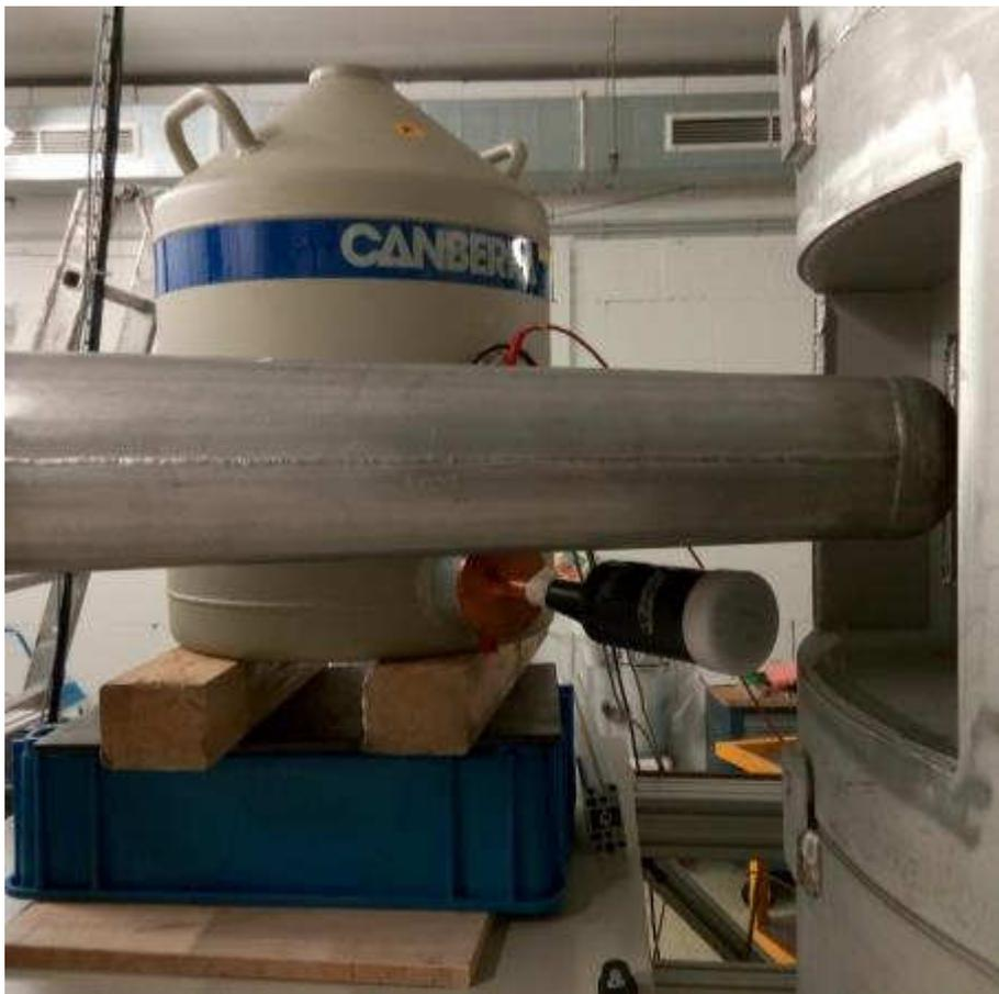
**Abbildung 4.** Radiologische Messungen von außen am Quecksilbertarget der JESSICA-Anlage. Oben: Messung mithilfe eines identiFINDERs. Unten: Messung mithilfe eines HPGe-Detektors.
