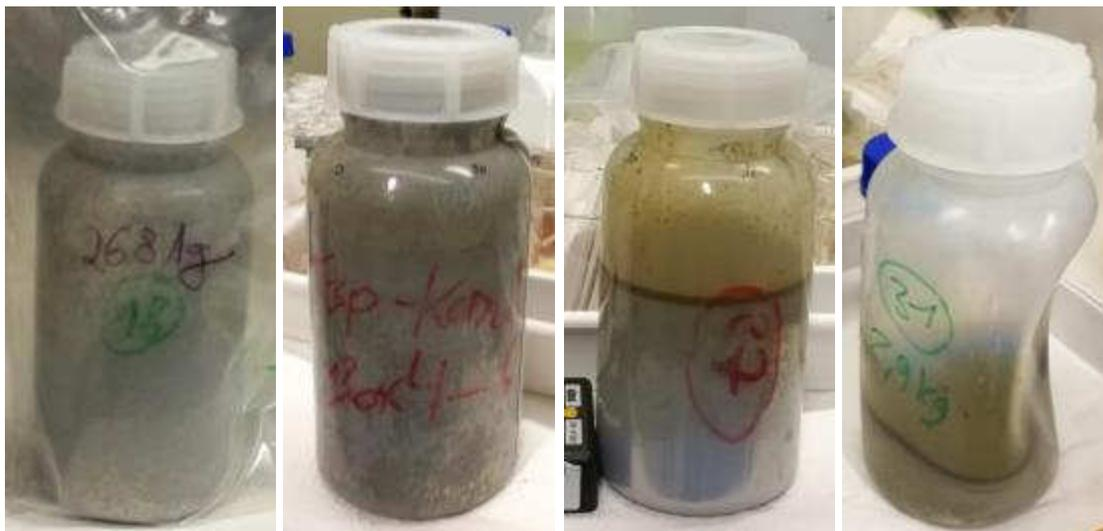
**Abbildung 5.** Untersuchte radioaktiv kontaminierte Quecksilberproben aus Jülich.
